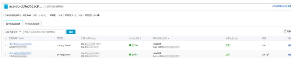
当您有传统的主备需求时，即后端服务器中有一台主机和一台备机，可选择使用主备服务器组。当主机正常工作时，流量将直接走主机；当主机不可用时，流量将走到备机，避免服务中断。
