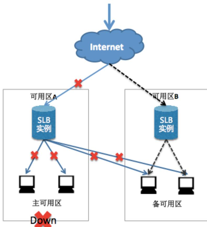
当可用区A未出现故障时，用户访问流量如上图蓝色实线所示；当可用区A发生故障时，用户访问流量的分发将变成如上图黑色虚线所示，这样就可以避免因为单个可用区的故障而导致对外服务的不可用。
