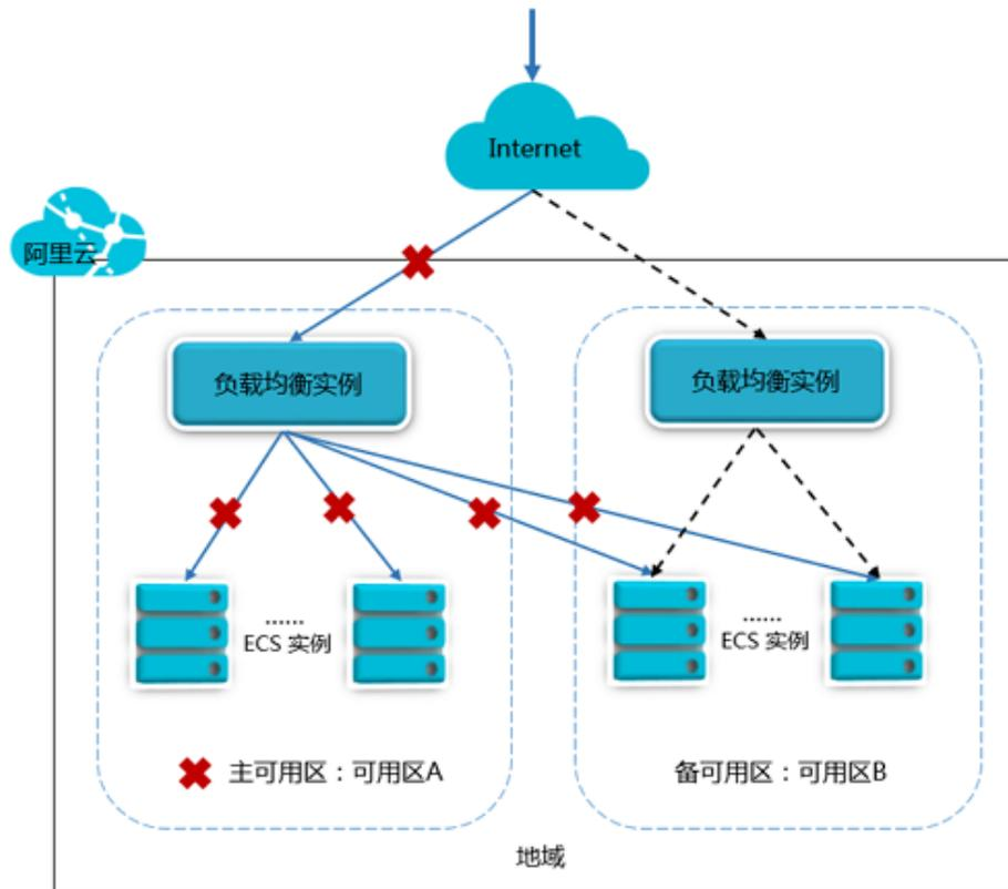
如果您采取如下图所示的部署方案，即在负载均衡实例的主可用区下绑定多台ECS实例，而在备可用区没有任何ECS实例。当主可用区发生故障时会造成业务中断，因为备可用区没有ECS实例来接收请求。这样的部署方式很明显是以牺牲高可用性为代价来获取低延时。
