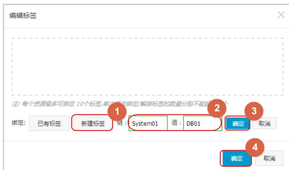
填写完所有要绑定的标签后，单击 **确定** 完成绑定。
