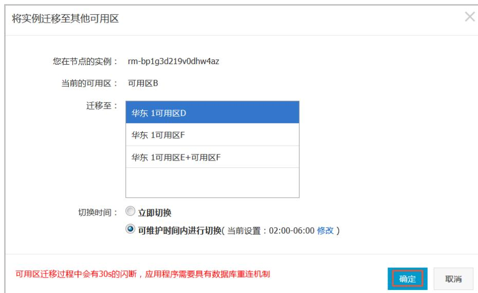
当RDS创建成功后，系统会在同一地域不同可用区（随机分配）内为该实例创建一个免费的备实例。主备实例的数据会实时同步，用户仅能访问主实例数据，备实例仅作为备份形式存在。但当主实例所在机架出现故障时，可进行主备实例的切换，切换后原来的主实例会变成备实例，可实现机架级别的容灾。本节将介绍主备实例切换方法。
