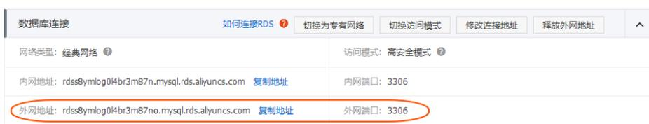
单击 **修改连接地址**，在弹出的窗口中设置内外网连接地址及端口号，单击 **确定**，如下图所示。
