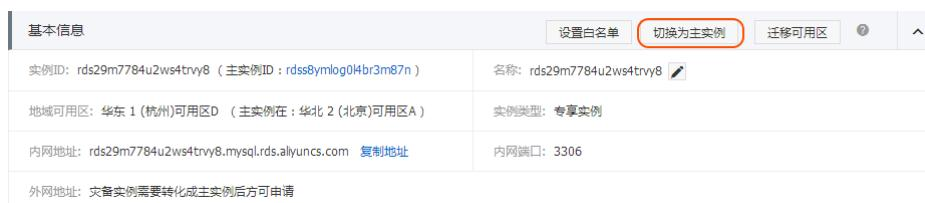
灾备实例切换为主实例后，与原主实例间的同步链路将自动断开，与原主实例不再有数据同步关系。灾备实例变成一个独立且具备完整功能的实例。
