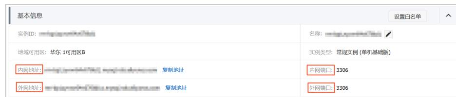
**端口**：若使用内网连接，需输入RDS实例的内网端口。若使用外网连接，需输入RDS实例的外网端口。
