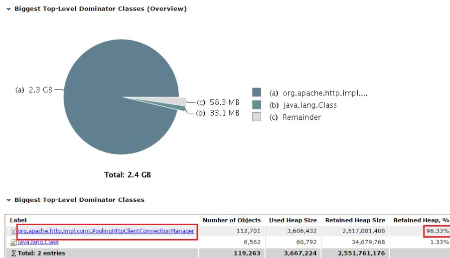
原因：程序中可能多次new OSSClient，但是没有调用OSSClient.shutdown，造成对象泄漏。提示new OSSClient一定要和OSSClient.shutdown成对使用。
