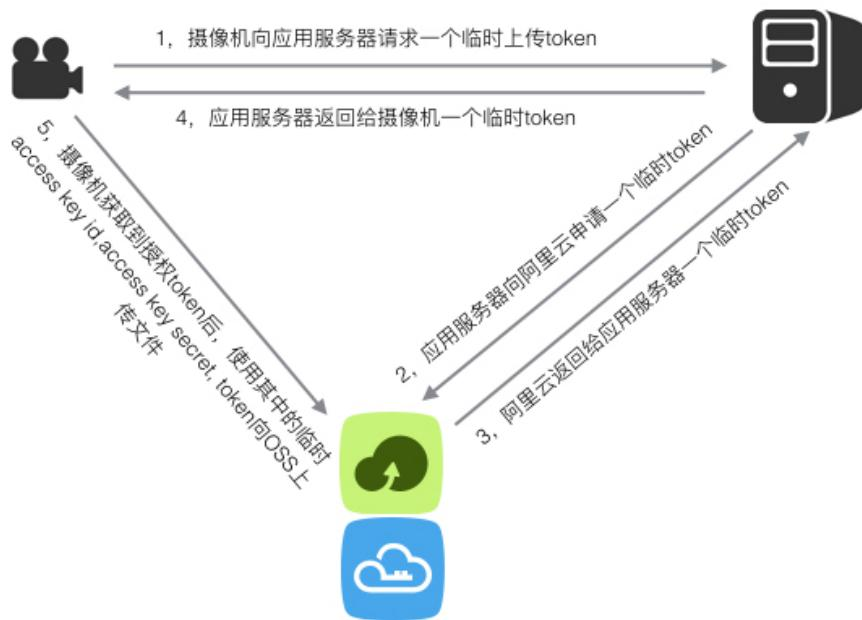
角色包括三个，网络摄像机，应用服务器，阿里云对象存储服务（OSS），网络摄像机内部使用OSS MEDIA C SDK的client部分，应用服务器内部使用OSS MEDIA C SDK的server部分。
