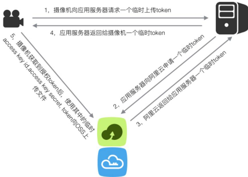
角色包括三个，网络摄像机，应用服务器，阿里云对象存储服务（OSS），网络摄像机内部使用OSS MEDIA C SDK的client部分，应用服务器内部使用OSS C MEDIA SDK的server部分，他们的流程如下：
