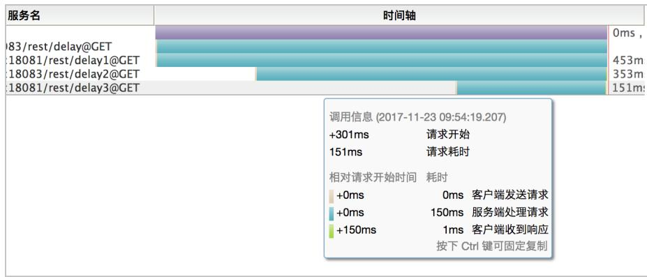
将鼠标停留在 delay3 这个调用段，还可以看到更多详细的调用链的信息。其中服务端处理请求花费了 150ms，客户端在服务端处理完请求后的 1ms 收到了响应。
