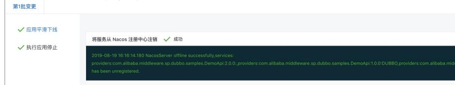
在执行应用停止流程中，会检测 Dubbo 应用是否开启了 QoS 端口，如已开启，则调用 offline 指令下线服务，停止应用的进程接收到指令后执行下线操作。
