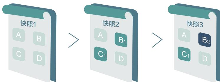
图中快照 1、快照 2 和快照 3 分别是磁盘的第一个、第二个和第三个快照。文件系统对磁盘的数据进行分块检查，当创建快照时，只有变化了的数据块，才会被复制到快照中。在该示例中：
