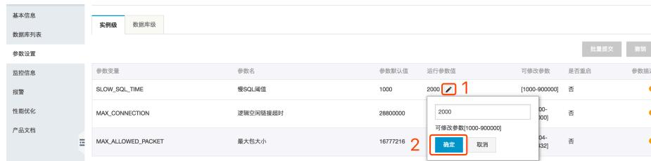
单击右上角的**批量提交**，提交修改的参数值，如下图的1所示。单击右上角的**撤销**，撤销还未提交的参数修改，如下图中的2所示。
