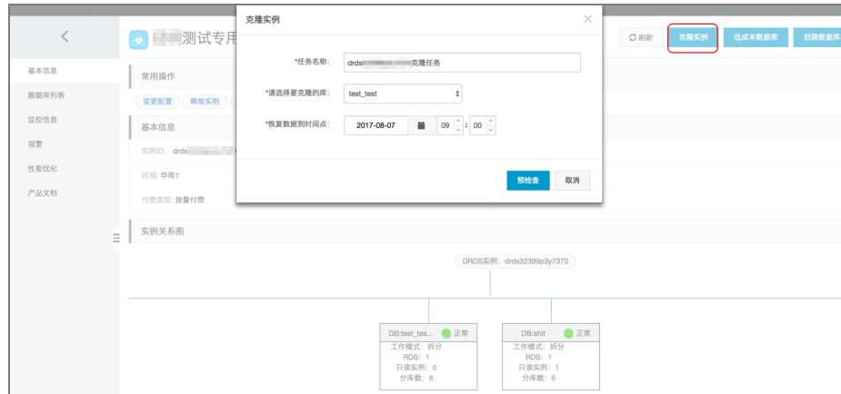
在**克隆实例**对话框，输入克隆任务名称，选择需要克隆的库，以及需要恢复的时间点，单击**预检查**。DRDS 会对实例的克隆能力进行检测，确保实例满足克隆条件。
