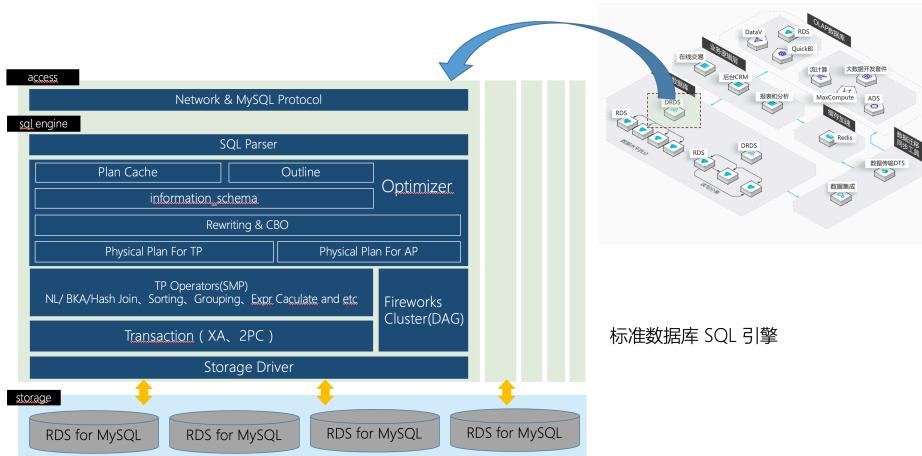
整个分布式 SQL 层如同大多数传统单机关系型数据库，分为网络层、协议层、SQL 解析层、优化层和执行层，其中优化层包含逻辑优化和物理优化，执行层包含单机两阶段执行、单机并行执行和多机并行执行，应用了多种传统单机数据库优化和执行技术。
