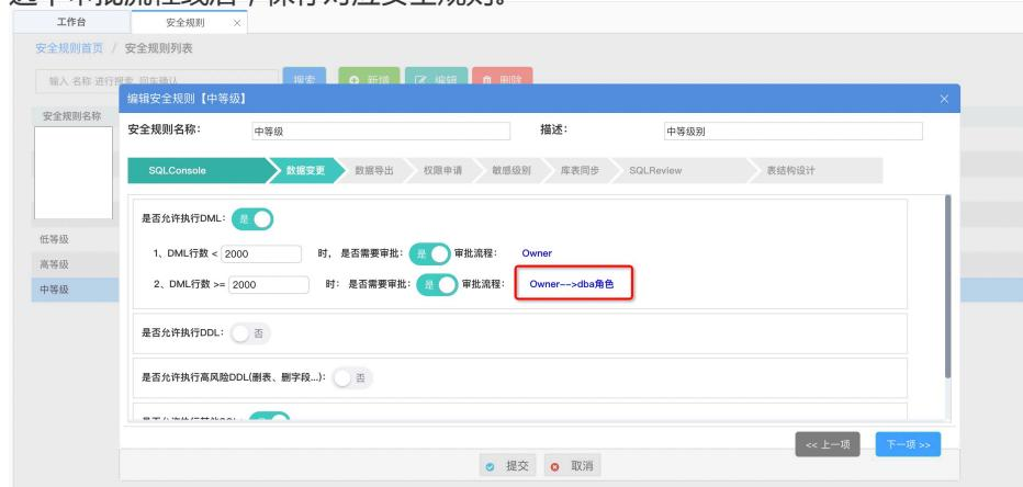
5 ) 后续新提交的数据变更流程，满足对应规则就会流转到新配置的审批流程线上。即满足多个DBA角色都可以接收到审批消息、处理审批流程的效果
