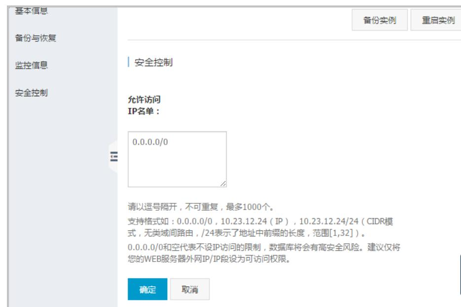
单击**加载ECS内网IP**，系统将显示同账号下的ECS内网IP，您可以选择ECS内网中的IP并添加到白名单中，单击**确定**。如下图所示：
