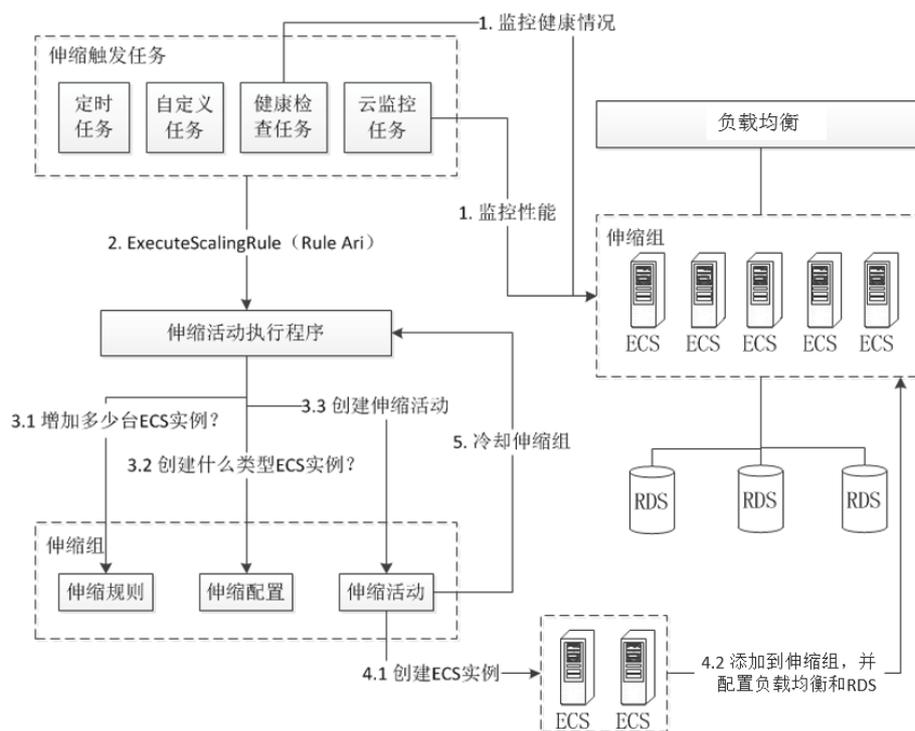
创建好伸缩组、伸缩配置、伸缩规则、伸缩触发任务后，系统会自动化执行以下流程（以增加 ECS 实例为例）：
