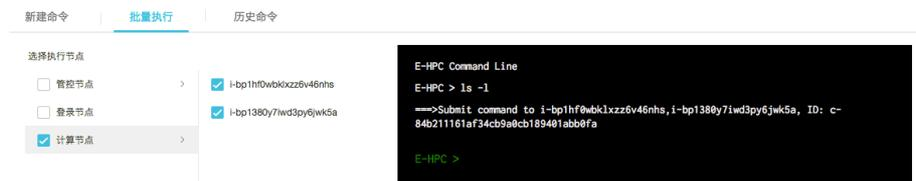
提交命令后，返回信息中会包含执行该命令的节点ID（多个）。当需要查询命令执行结果时，需要使用cmd\_result命令并带上具体的命令ID、实例ID来查询：
