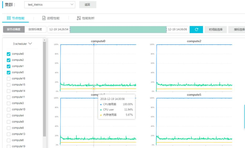
如上图所展示，为作业3.scheduler下4个计算节点的性能信息，包含CPU使用率、内存使用率、CPU user 三项指标。
