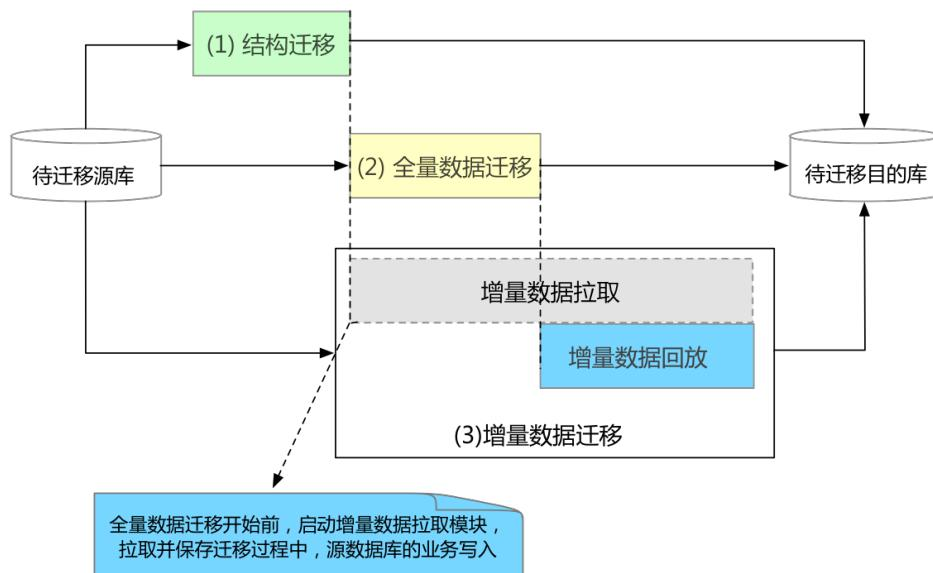
不停服迁移的迁移类型需包含结构迁移、全量数据迁移及增量数据迁移三个阶段。当进入增量数据迁移阶段时，目标实例会保持跟源数据库之间的数据实时同步，用户可以在目标数据库进行业务验证，当验证通过后，直接将业务切换到目标数据库，从而实现整个系统迁移。
