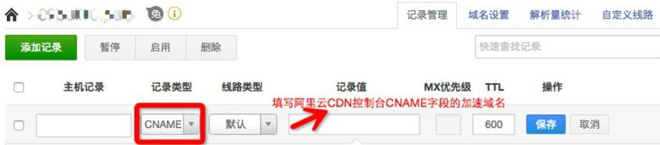
填写主机记录，记录类型选择CNAME，线路类型选择（默认为必填项，否则会导致部分用户无法解析；除了联通用户之外的所有用户，选择默认即可），在记录值一栏填写“CDN控制台中CNAME字段的加速域名”，无需修改TTL时间
