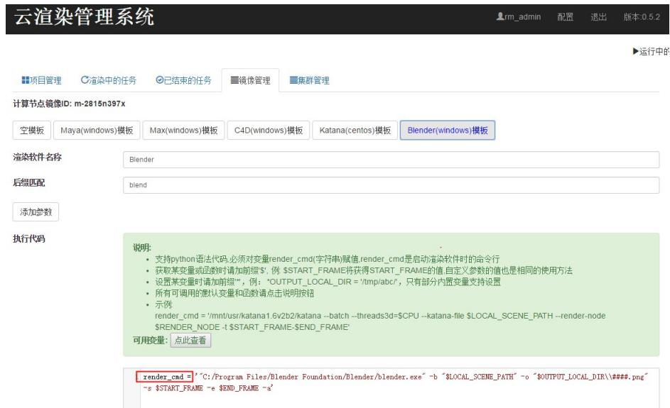
渲管已经预定义了一些变量和函数，在执行代码中可以调用这些变量和函数，例如\$CPU在执行期会被替换成实际的cpu核数，\$START\_FRAME在执行期会被替换成起始帧号。
