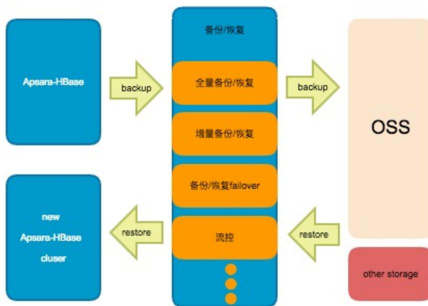
云HBase自研了支持HBase的备份恢复功能，上图为云HBase备份恢复基本的组成图，由全量数据备份/增量（实时）数据备份/全量数据恢复/增量数据恢复等几个大的模块组成，此外还有failover、流控等处理特性。云HBase的数据会通过备份系统把数据备份到OSS或者其他存储系统，现阶段默认备份到OSS（**由于备份数据量大，会存在部分额外开销**），整个备份恢复系统全自动化，用户只需要触发备份按钮即可，无需额外复杂操作。
