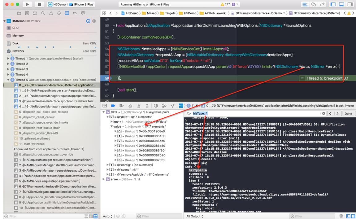
上一步检查通过后，在加载离线包的 finish 回调方法里查看离线包信息，确保为控制台发布的最新包，且 error = nil，检查离线包的 appId、version、main\_url 等是否正确。
