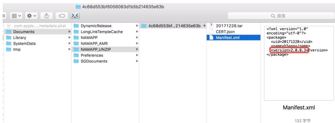
若上一步中沙盒目录下无对应离线包，可先暂时关闭离线包验签，删除 App 重新运行。若关闭验签后加载正常，说明离线包加签私钥和客户端验签公钥不一致，请更新客户端对应的公钥信息。
