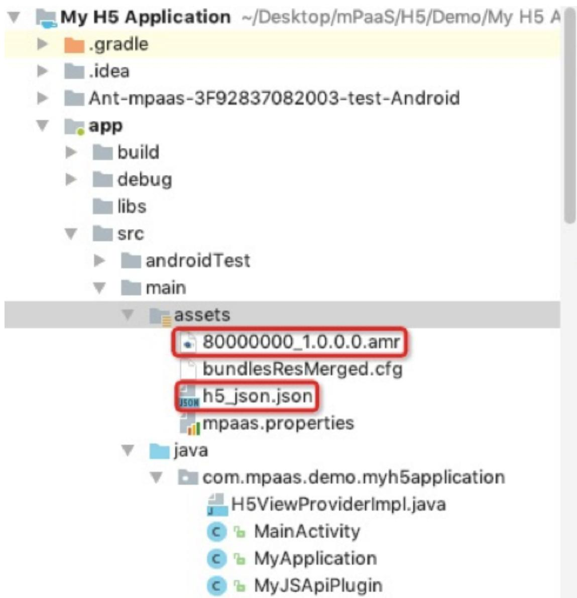
将离线包预置到应用内。推荐在 App 启动的时候注册，在本教程中在 MyApplication 类中进行注册。至此，您已经完成 预置离线包。
