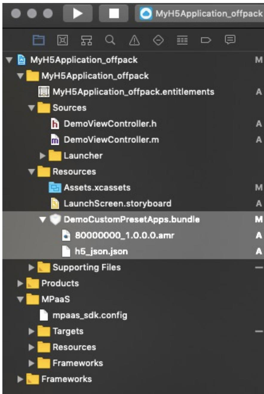
向容器注册预置的离线包。将包含预置离线包信息的 plist 文件和离线包的路径分别赋给 presetApplistPath 和 appPackagePath，通过 initNebulaWithCustomPresetApplistPath 进行初始化。至此，您已经完成 **预置离线包**。
